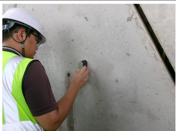
경사계를 이용한 경사도 측정
